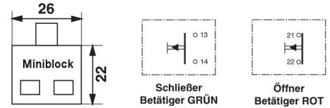
Schalteinsatz, Micro-Taster (1 **Schließer**) für Schlüsselschalter Baureihen MS/MSR/MR für Drucktaster Baureihen KDT/RDT/J/S
