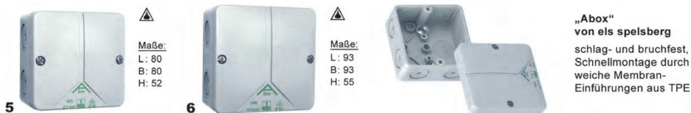
**Technische Daten:** Deckelbefestigung: geschraubt, Kasten: Polycarbonat, Membranen: TPE, Deckel: Polystyrol, Farbe: grau, Schutzart: IP 65, max. Leiterquerschnitt 2,5 mm<sup>2</sup>, Kabeleinführungen: 8 x M20, Dichtbereich: 2 - 16 mm
