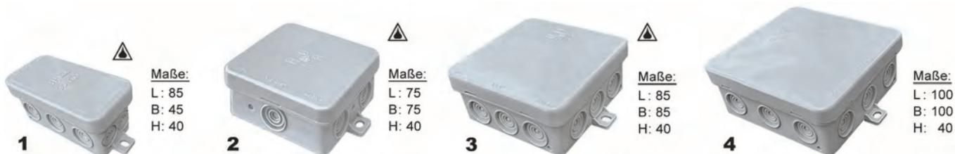
**Technische Daten:** Deckelbefestigung: schraublos, Kasten und Deckel: Polyethylen, Farbe: grau, außenliegende Befestigungslaschen, Schutzart: IP 54, für Leitungen bis 5 x 2,5 mm<sup>2</sup>, mit bis zu 12 Leitungseinführungen
