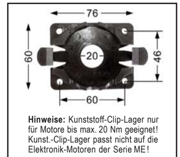
Vorbau-/ Blendkappenlager aus Kunststoff mit Clipsystem Bestell-Nr.: DM-L015
